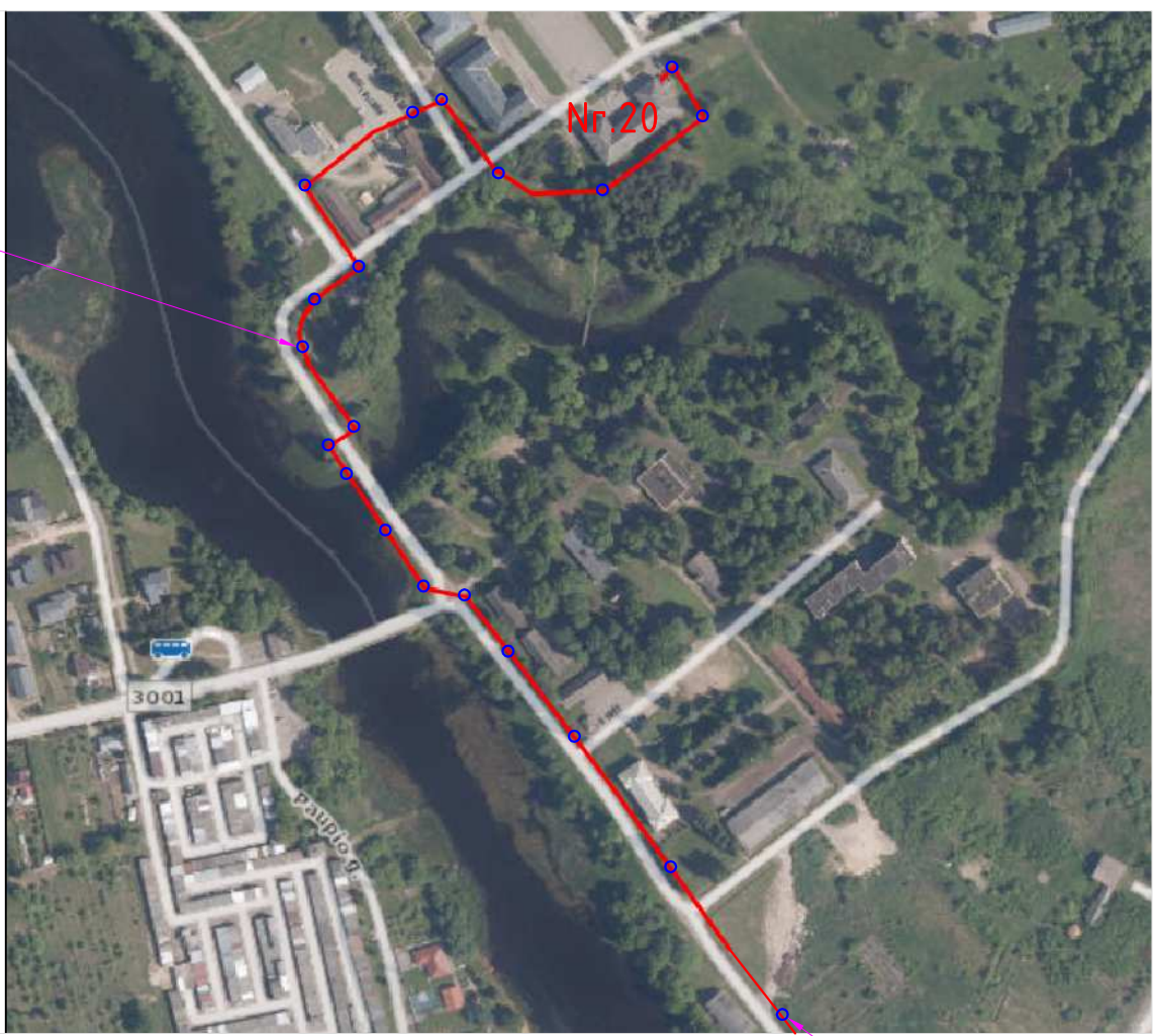
ESAMOS RYŠIŲ KANALIZACIJOS TRASA IKI 20 PASTATO
